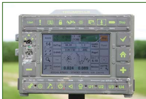
Рис. 3 Вид приемника TRIUMPH-LS после падения
